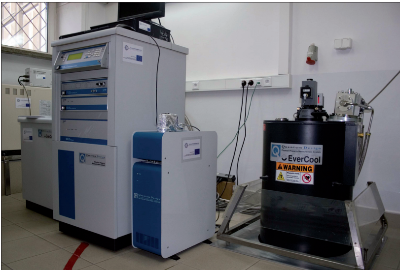
Fot. 2002/1. Nowa aparatura w Katedrze Fizyki Ciała Stałego. Zdjęcie górne: spektrometr kątowo-rozdzielczy ultrafioletowej fotoemisji elektronowej ARUPS (ang. Angle-Resolved Ultraviolet Photoemission Spectroscopy ) firmy Omicron, uruchomiony we wrześniu 2002 r. w przyziemiu C-1. Od lewej: mgr R. Zalecki i prof. A. Kołodziejczyk. Zdjęcie dolne: wielofunkcyjny przyrząd Physical Property Measuring System firmy Quantum Design, uruchomiony w lutym 2007 r. Umożliwia pomiary różnych własności termicznych, magnetycznych i elektrycznych materiałów w zakresie temperatur od 2 K do 400 K i w funkcji pola magnetycznego do 9 T (Fot. J. Przewoźnik)
