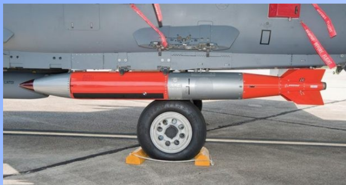
Prototyp bomby/rakiety B-61-12, 03 – 50 kton, kierowanej przez GPS (USA, w 2020 w produkcji 500 sztuk)
